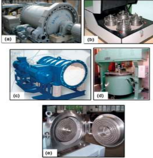
Şekil 2. Endüstriyel amaçla kullanılan değirmenler (a) Döner tamburlu değirmen, (b) Gezegenel değirmen, (c) Titreşimli değirmen, (d) Karıştırma değirmen, (e) Milli değirmen (Göktaş, 2013).
