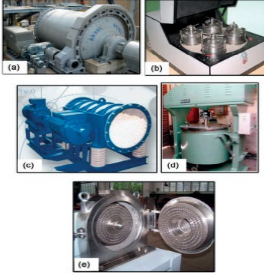
Şekil 2. Endüstriyel amaçla kullanılan değirmenler (a) Döner tamburlu değirmen, (b) Gezegensel değirmen, (c) Titreşimli değirmen, (d) Karıştırma değirmen, (e) Milli değirmen (Göktaş, 2013).
