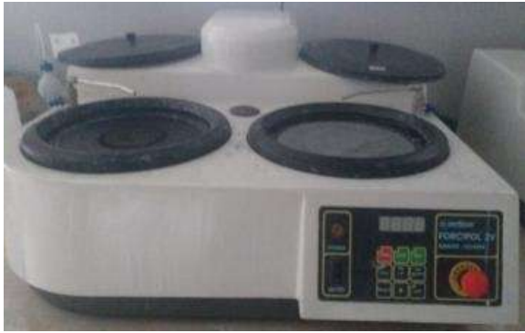
Şekil 4. Forcipol 2V grinder-polisher cihazı
