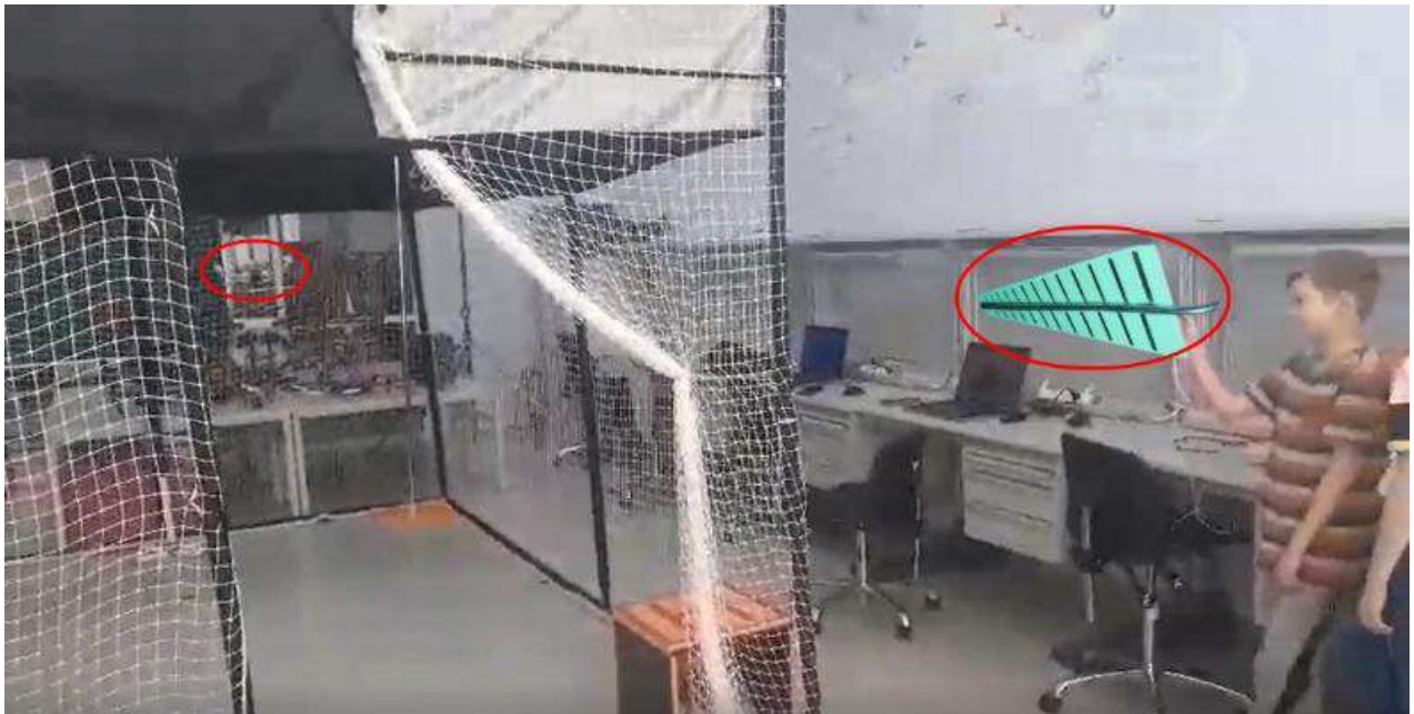
Рисунок 7. Кадр с испытаний. Красным овалом выделены БПЛА и направленная антенна (логопериодическая антенна наложена в виде картинки, так как ее в кадре не видно из-за формата плоскости логопериодической антенны)
