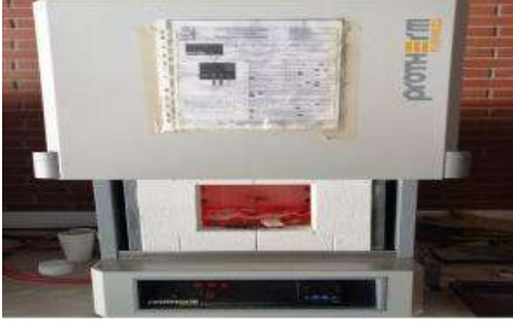
Şekil 1. Isıl işlem için kullanılan elektrikli fırın
