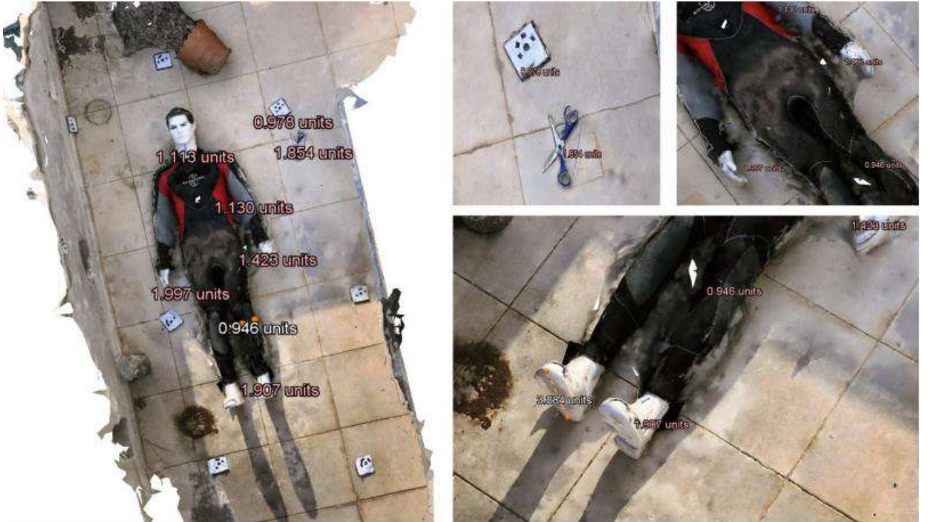
Şekil 5. Olay Mahalline Ait 3B Mesh Modelden Elde Edilen Ölçümler.
