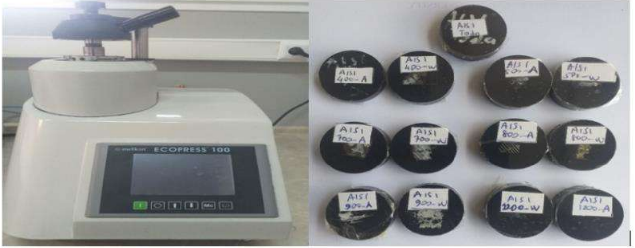
Şekil 3. Ecomet 100 bakalite alma cihazı ve bakaliteye alınmış test numuneleri
