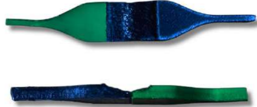
ABS Plus- PA6 GF30, Deney 7 Çekme Dayanımı: 11.71 MPa
