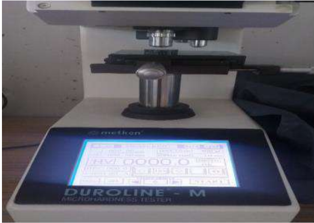
Şekil 6. Duroline-M microhardness tester cihazı
