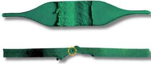
ABS Plus- ABS Plus, Deney 7 Çekme Dayanımı: 22.19 MPa
