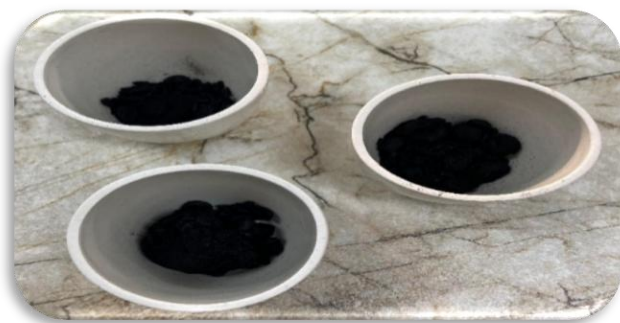
Сурет 3- Долана жемісіндегі жалпы күл мөлшерін анықтау
