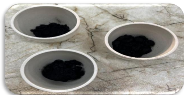
Сурет 3- Долана жемісіндегі жалпы күл мөлшерін анықтау
