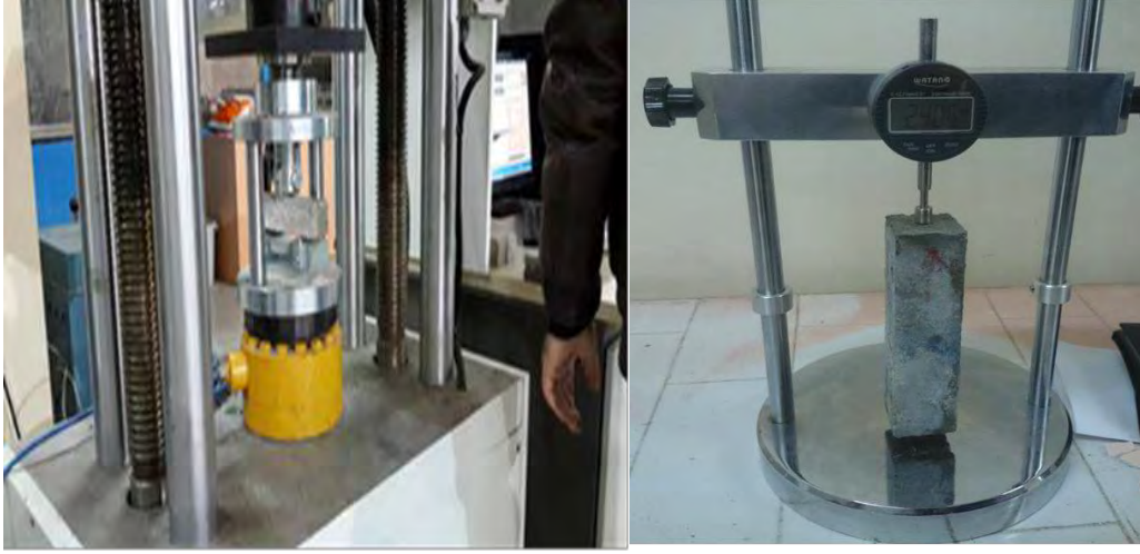
Şekil 2. Harç numunelerinde eğilme dayanımı ve boy değişimi deneyi
