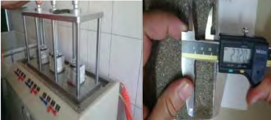
Şekil 1. Basınç altında su işleme derinliğinin tayini
