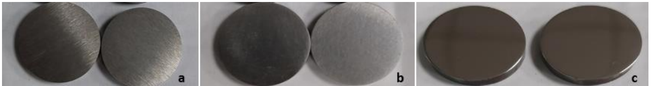
Şekil 1. Yüzeyleri işlenmiş numuneler kaba taşlama (a), ince taşlama (b), polisaj (c).
