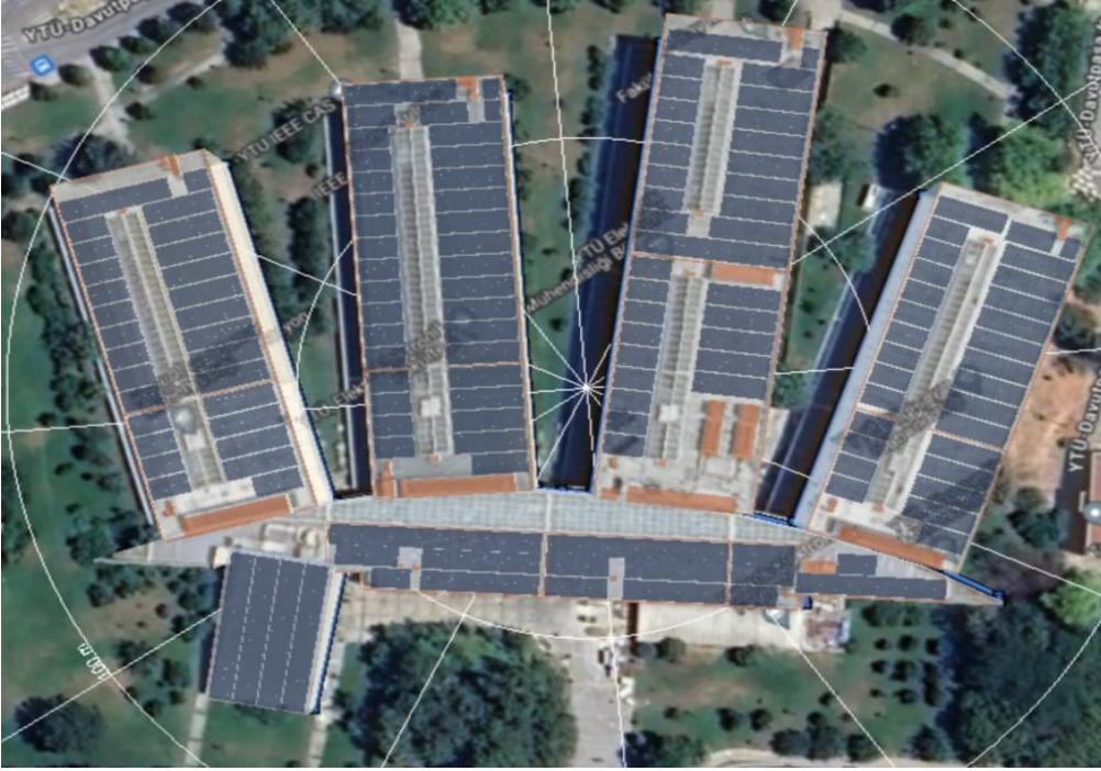
Şekil 7. PV-SOL Premium yazılımı ile YTÜ Elektrik-Elektrik fakültesi pv panel tasarımı
