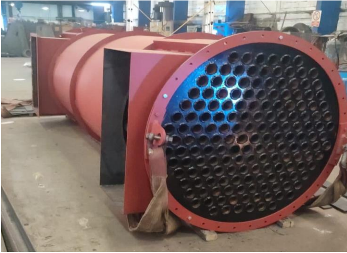
Şekil 1. İmalatı yapılan gövde borulu eşanjör.
