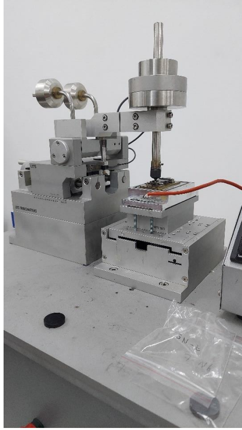
Şekil 3. Aşınma test düzeneği.
