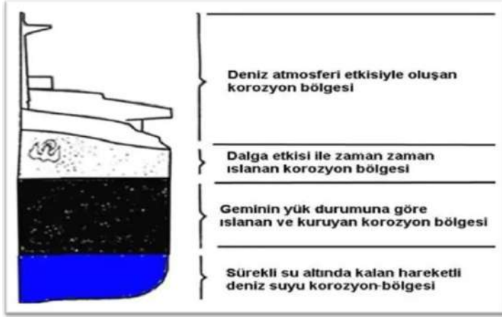
Şekil 8. Gemi metalinin korozyon bölgeleri [9, 10]
