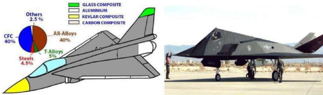
Şekil 15. Savaş uçağında gövde ve kanatta CFRP kompozit kullanımı [38]
