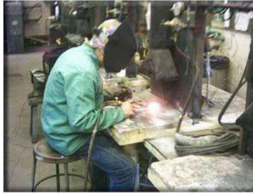
Şekil 5. Gaz Ergitm Kaynağı
