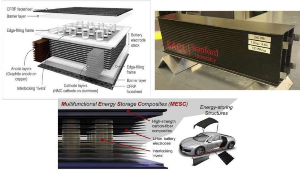
Şekil 9. CFRP plakalarına sabitlenmiş tüm kalınlıkta polimer perçinlere sahip lityum iyon pil elektrot hücresi [24]
