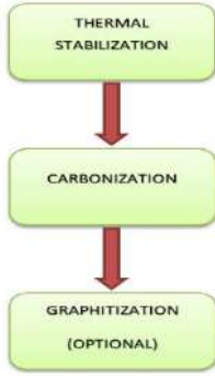
Şekil 1. Karbon lifin üretim akış şeması [7-11]
