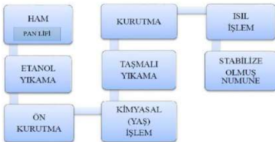
Şekil 3. Ham PAN lifinin stabilize işlem basamakları
