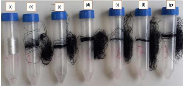
Şekil 12. Stabilize viskoz rayon numunelerdeki renk değişimleri: (a) Ham viskoz rayon, (b) 5 dk, (c) 10 dk, (d) 15 dk, (e) 20 dk, (f) 25 dk, (g) 30 dk
